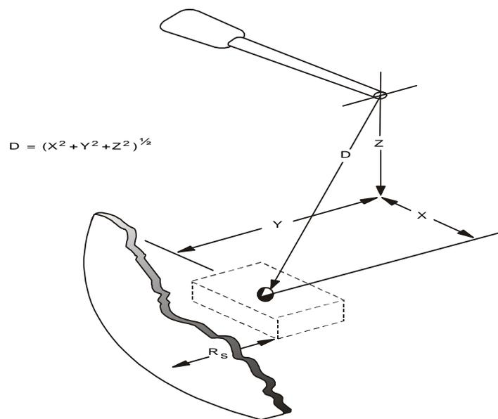
**FIGURE 519.5D-2. The distance parameter (D) and the depth parameter (R<sub>s</sub>)**
